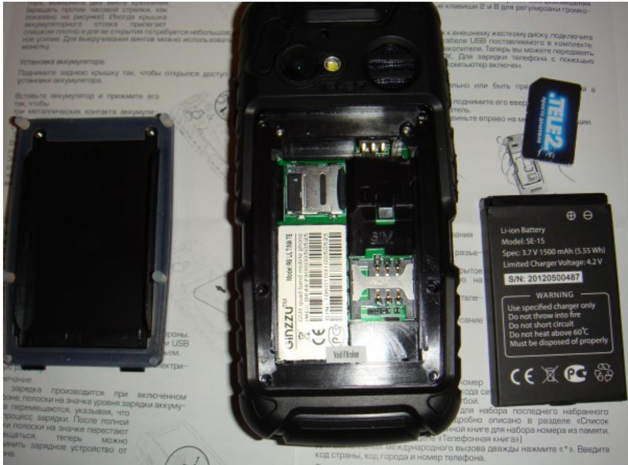
Итак, пора собрать телефон, откручиваем 2 винта, снимаем крышку, ставим сим-карту, вставляем аккумулятор, дальше аккуратно укладываем резиновую прокладку в пазы и зажимаем крышку винтами, тут главное не переусердствовать.
