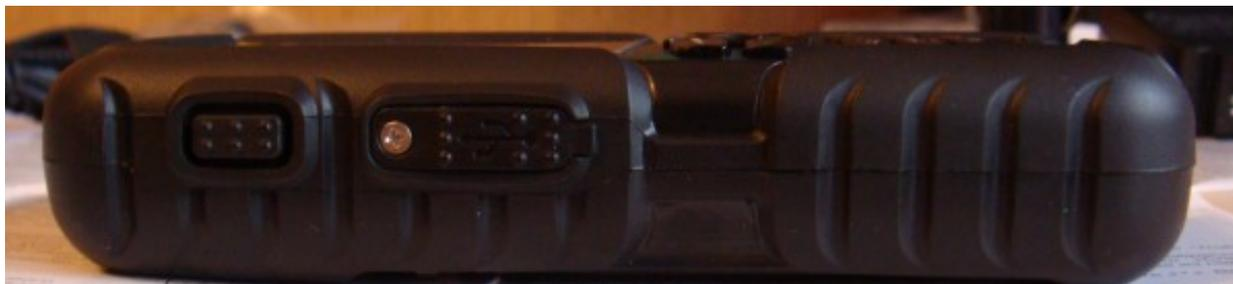
Помимо клавиатуры на телефоне всего две кнопки. Слева кнопка быстрого вызова навигации, справа кнопка рации. Мне, конечно, не хватает качельки громкости, но это опять придирки.
